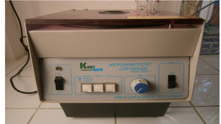
Foto 7: Centrifugación para separación de suero
