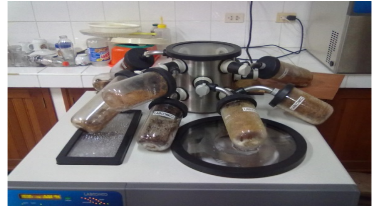
Foto 15: Proceso de liofilización de los extractos acuosos.
