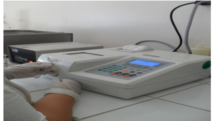
Foto 11: Lectura de absorbancia usando espectrofotómetro para luego hacer el cálculo de la glicemia
