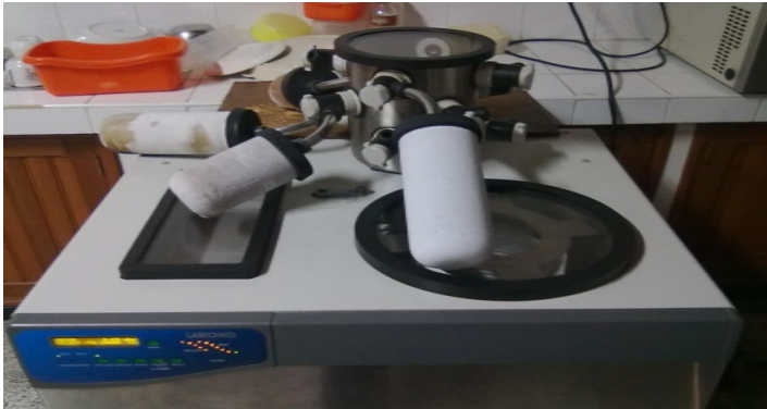
Foto 14: Proceso de liofilización de los extractos acuosos.
