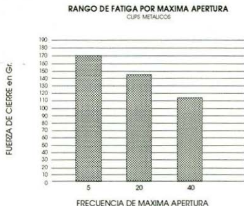
Figura 5.- Fatiga del clip por sucesivas aperturas que tiene relación directa con el número de veces que se repita la maniobra.
