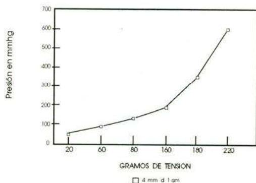
Figura 3.- Presión en mmHg intraluminal necesaria para provocar permeabilidad en arterias aorta de pollo de 4 mm de diámetro usando clips de 7 mm con diferente fuerza de cierre
